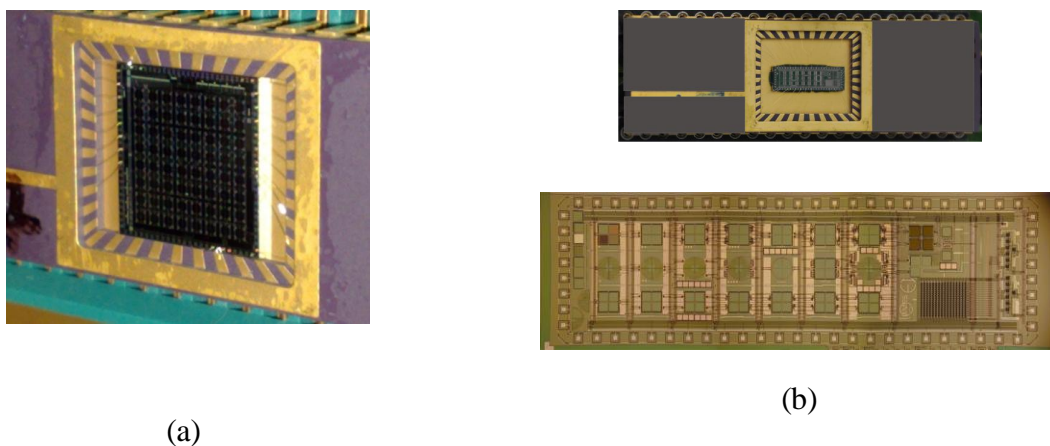
Fig. V-1 – Fotografias ilustrativas: (a) WFS com 64 QCs e píxeis passivos em funcionamento no laboratório ( OPTMA_lab. ). (b) Chip contendo as novas estruturas de teste propostas e utilizadas nesse trabalho.
