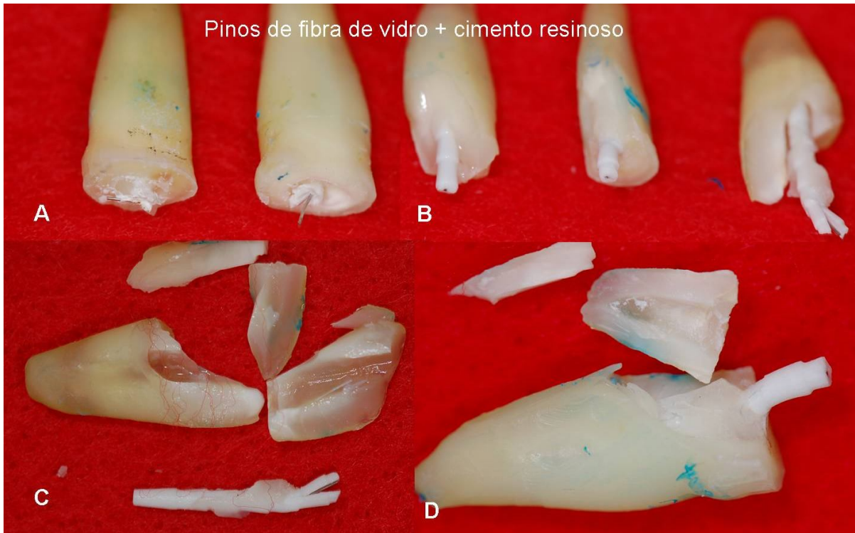
FIGURA 6.25 – Tipos de fraturas ocorrido no grupo de pinos de fibra de vidro e cimento resinoso. A- fratura no terço cervical; B- fratura no terço médio; C- fratura cominutiva no terço médio; D- fratura no terço médio –integridade do pino
