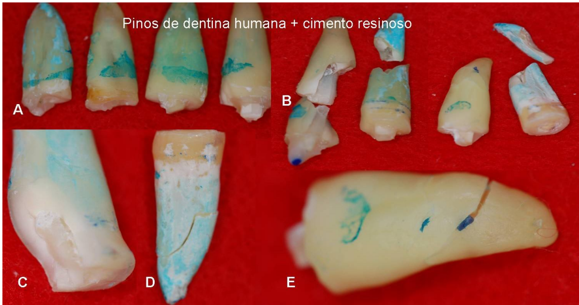
FIGURA 6.22 – Tipos de fraturas ocorrido no grupo de pinos de dentina humana e cimento resinoso. A- fratura no terço cervical; B- fratura no terço apical; C- fratura no terço médio; D e E- fratura no terço médio e apical
