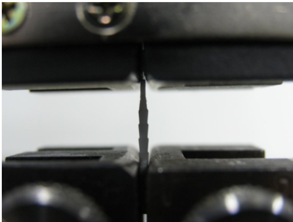
FIGURA 6.1 - Ensaio de tração em pino de fibra de vidro. Fenômeno de estrição na porção superior do pino perto da garra
