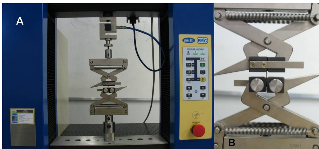
FIGURA 5.4 – A- Máquina de ensaios EMIC DL-10000; B- par de garras miniatura autotravante para polímero (Emic GR 001) com corpo de prova posicionado.
