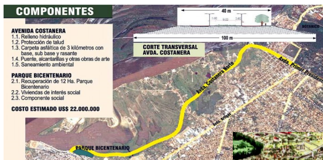
FIGURA 241: Linha e elevação a ser seguida para a via costeira.
