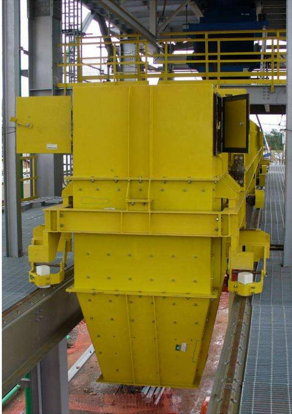
FIGURA 2.5. Chute de descarga de um transportador de correia móvel. (Imagem cedida pela Koch do Brasil Projetos Industriais Ltda)
