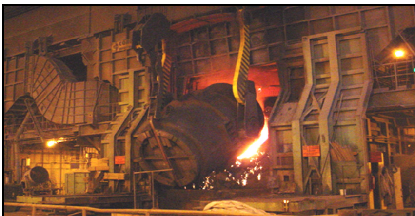
FIGURA 3.1 – Carregamento de gusa no vaso do convertedor MRP-L.
