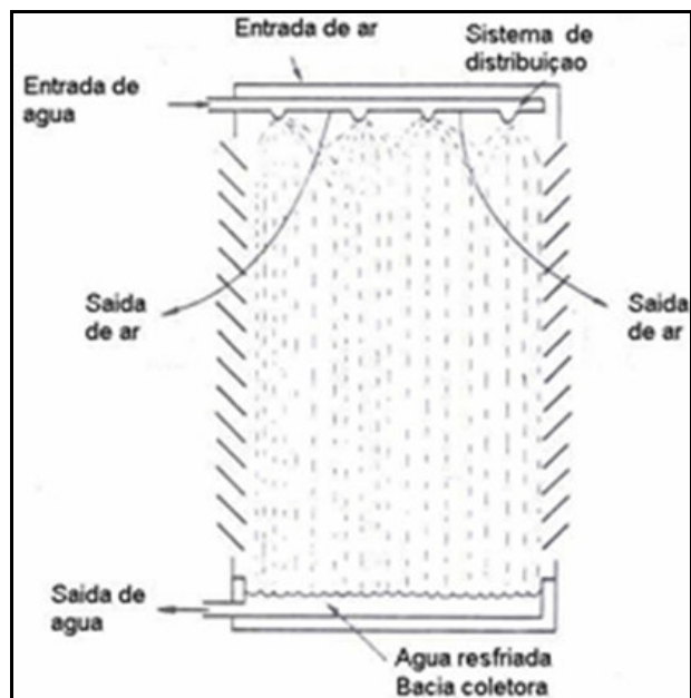
FIGURA 2.3 - Torre de resfriamento atmosférica.
