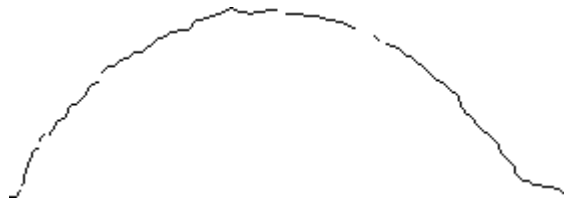
Figura 4.2 - Curva representativa da borda do cordão de solda.
