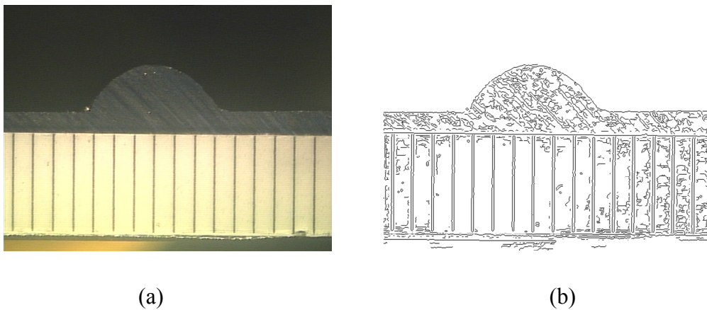
Figura 4.1 - (a) Imagem do cordão de solda.
