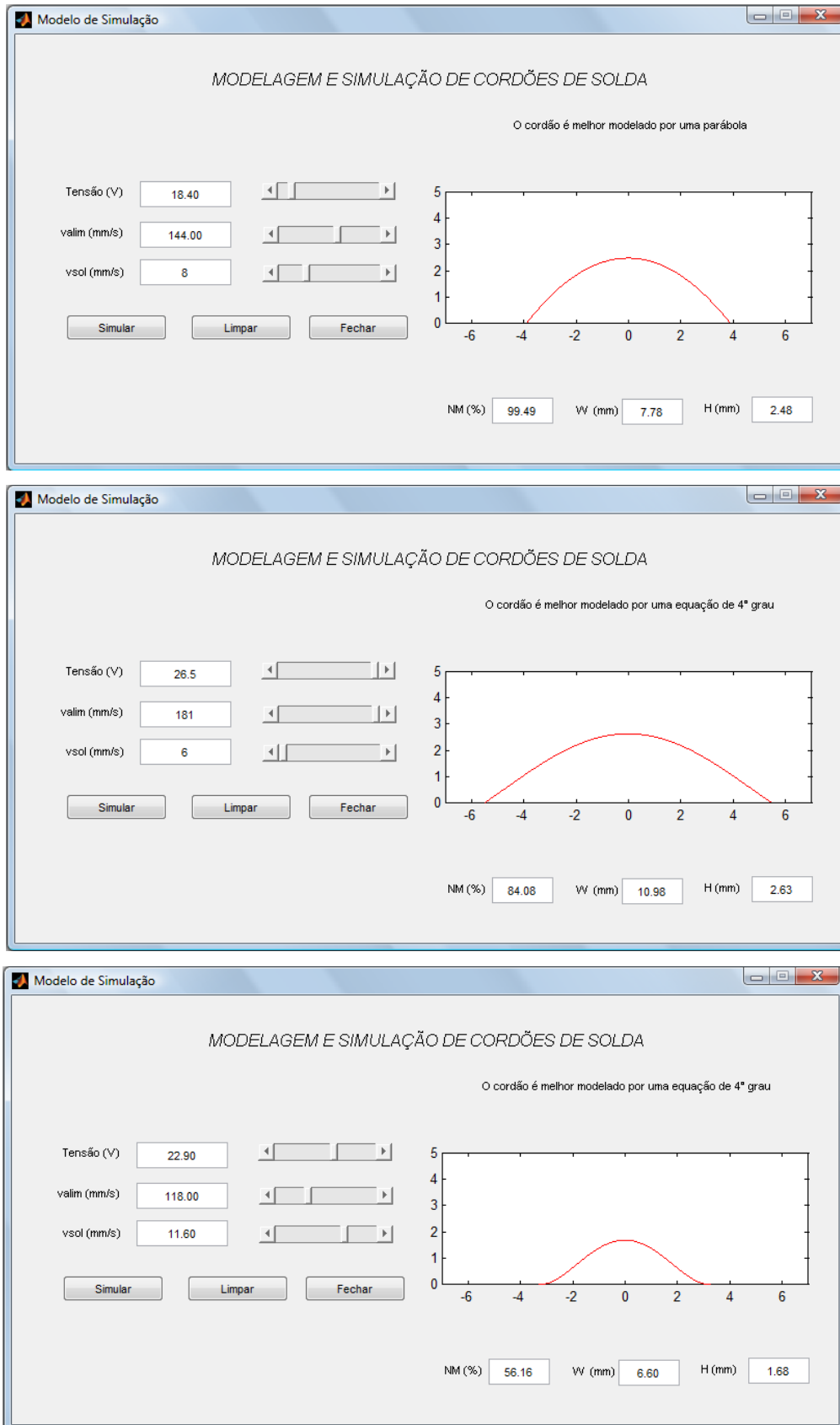
Figura 4.24 – Diferentes telas obtidas através da Simulação da geometria de cordões de solda a partir dos parâmetros de soldagem. Tela da Interface gráfica criada no MATLAB®.
