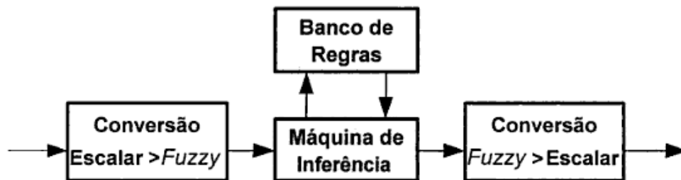
Figura 2.21 – Diagrama típico de um modelo de inferência de Mamdani
