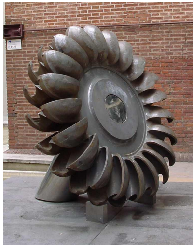
FIGURA 2.6– Rotor de uma turbina do tipo Pelton, mostrando a estrutura das pás. FONTE – http://upload.wikimedia.org/
