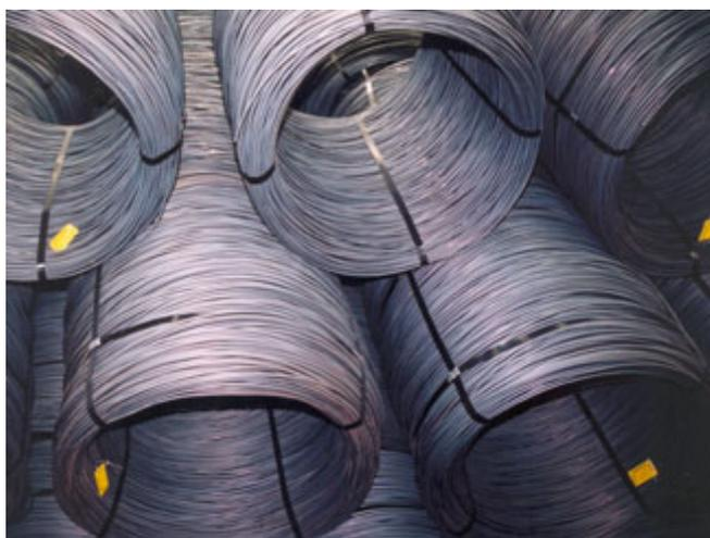
Figura 3.3 – Bobinas de fio-máquina
