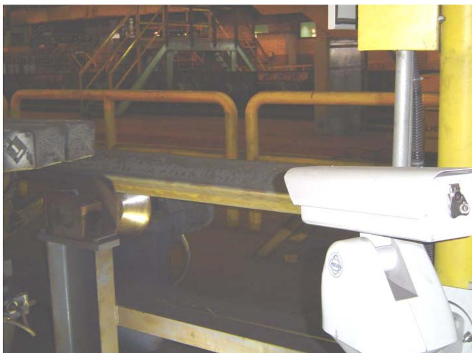
Figura 4.5 – Posicionamento da câmera focando a mesa de rolos
