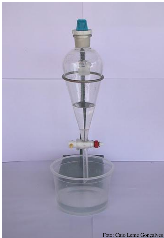
Figura 4. Funil de decantação e extração líquido-líquido de compostos provenientes da água de criação de larvas.
