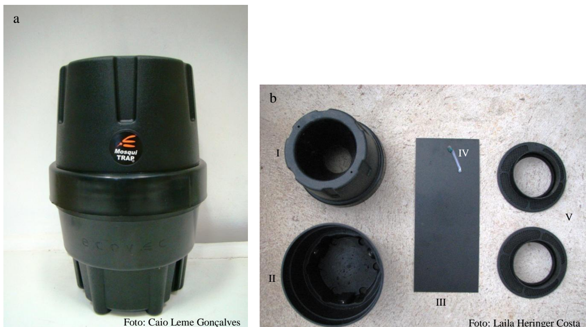
Figura 2. Armadilha MosquiTRAP ® : a) Armadilha montada; b) Componentes da armadilha: base (II), tampa (I), cartão adesivo (III), AtrAedes ® (IV) e suporte para cartão adesivo (V).
