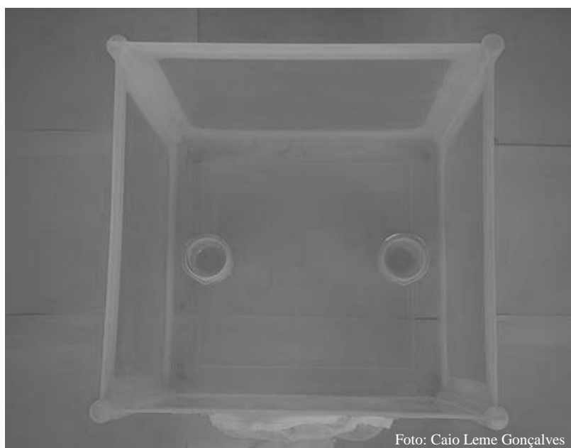
Figura 5. Gaiola de polipropileno (com a parte superior removida) utilizada para os testes de dupla escolha contendo dois recipientes para oviposição e uma única fêmea/teste de Aedes aegypti .
