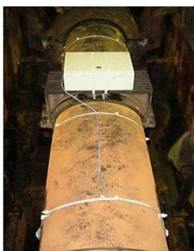
Figura 3-38 Caixa de aquisição de dados acoplada ao eixo do *spindle* do Laminador de Chapas Grossas.
