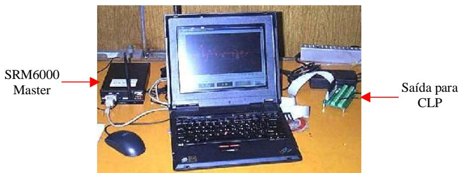
Figura 3-39 Conjunto de recepção, processamento e apresentação dos dados.
