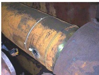
Figura 3-36 *Strain gage* colado no eixo do *spindle* do Laminador de Chapas Grossas.
