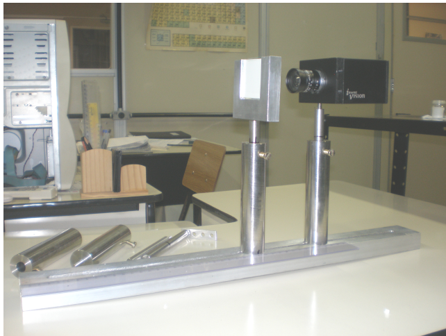
Figura 36: Em (a), fotografia do banco óptico fabricado com quatro cavaletes de altura regulável, e em (b) fotografia da montagem dentro da caixa de ferro de proteção radiológica
