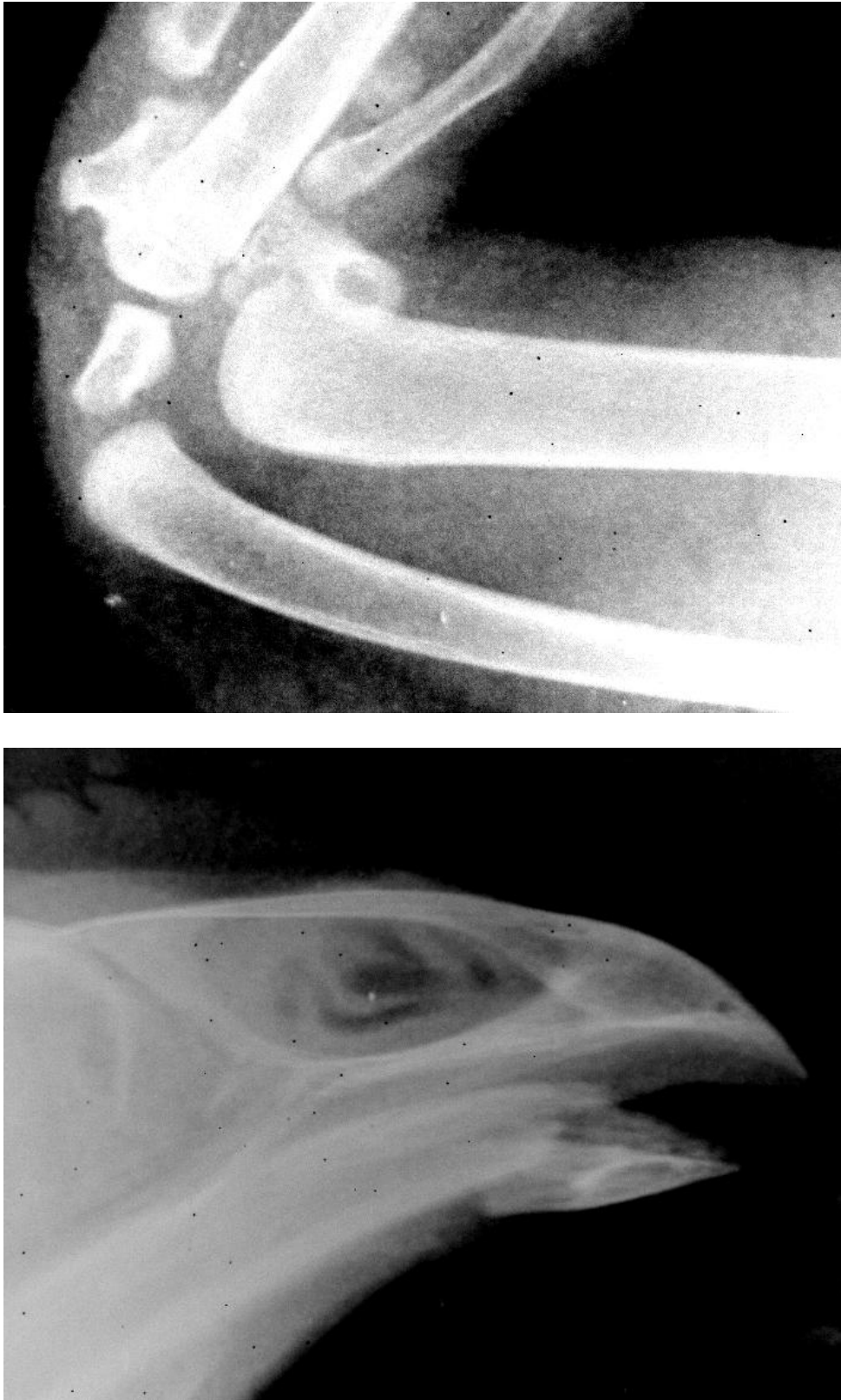
Figura 51: Radiografias de uma asa de frango, em (a), e de um bico de frango, em (b). As duas radiografias foram feitas com filmes cintiladores produzidos por sedimentação. Observe que as partes claras correspondem a materiais que atenuaram melhor o feixe de raios X, pois as imagens passaram por um processo de inversão de contraste (L.U.T.).
