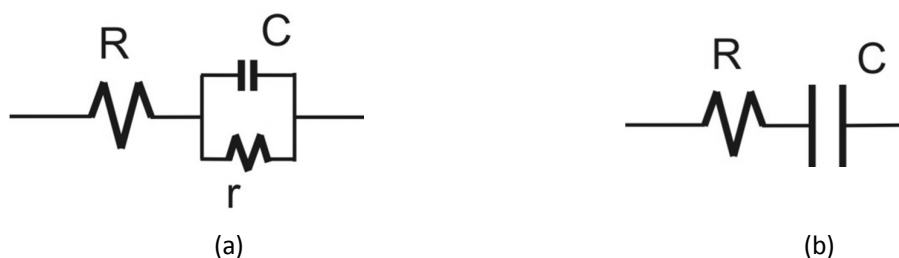
Fig. 5.1.1: (a) uma Resistência em série com um capacitor e um resistor em paralelo ( R_sC_{rp} ). (b) uma resistência em série com um capacitor ( RC_s ).
