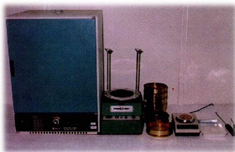
Figura 5: Equipamentos utilizados para a determinação do DGM do milho e das rações (Zanotto et al., 1998b)
