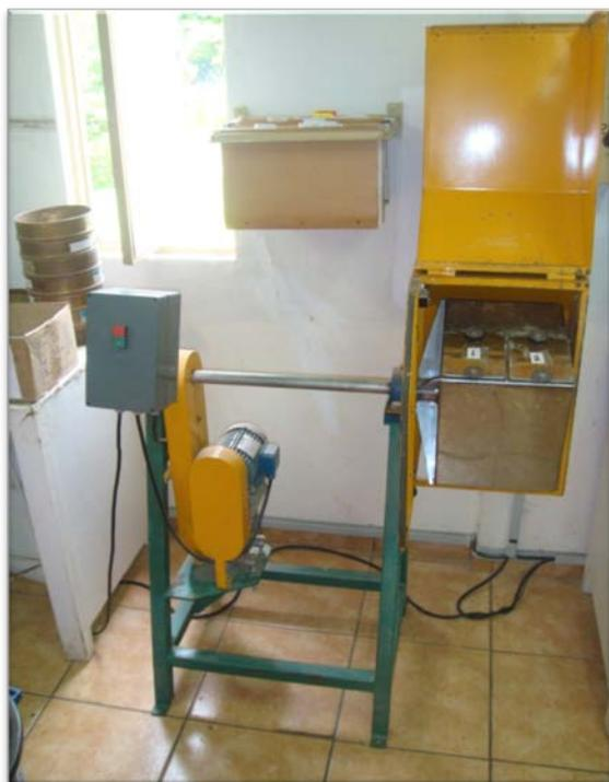
Figura 6: Durabilímetro
