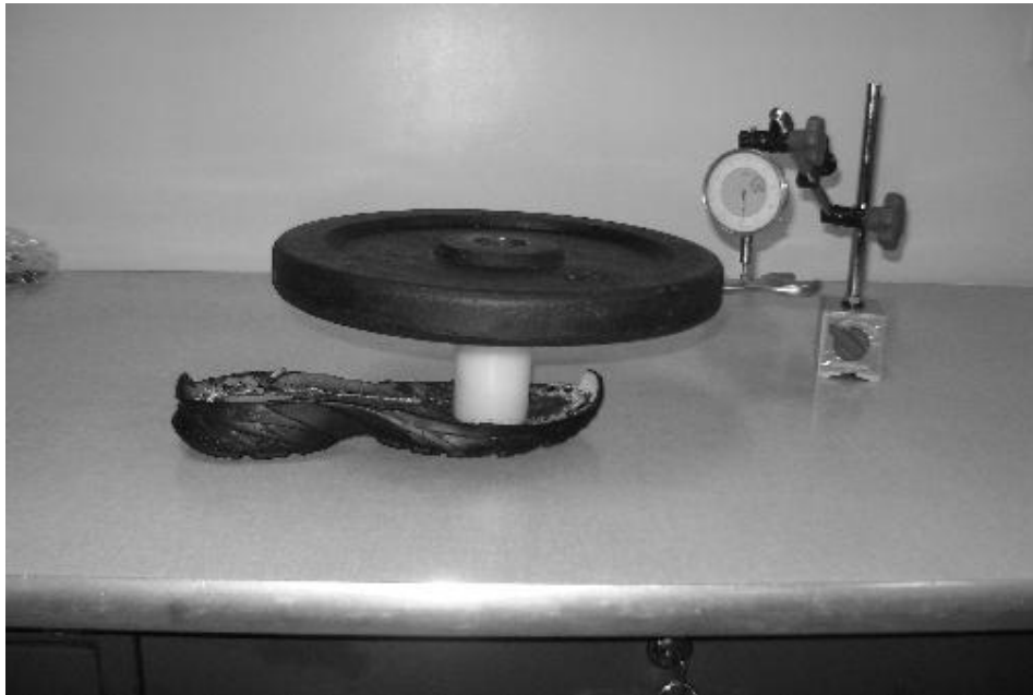
FIGURA 5: Mensuração da rigidez da parte anterior da entressola.
