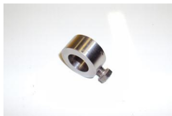
FIGURA 2: cilindro de aço inox utilizado para manipular a distribuição de massa da haste.
