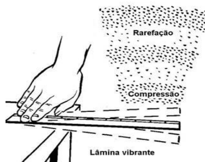
Figura 46 - Onda sonora vista bidimensionalmente produzida pela vibração de uma lâmina.
