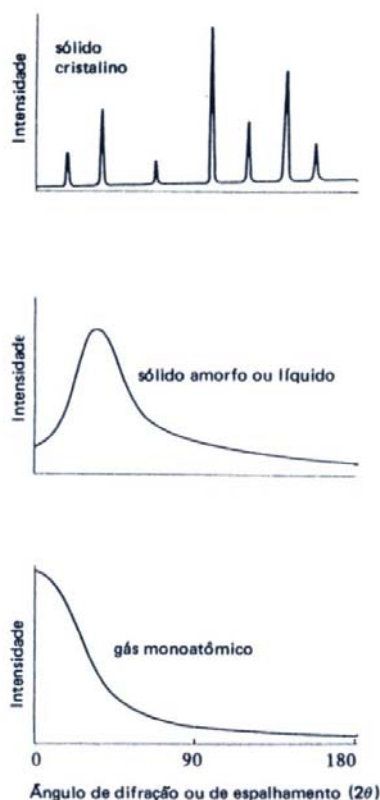
Figura 7: Espectros de difração (espalhamento) comparativos de um sólido cristalino, de um líquido ou sólido amorfo e de um gás monoatômico (PADILHA & FILHO, 2004).
