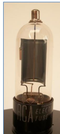
Figura 3.3 – Exemplo de célula fotoelétrica (RCA 935).
