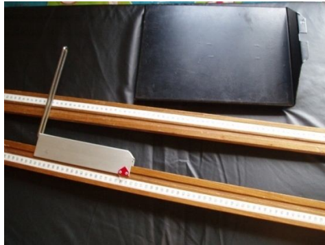
FOTOGRAFIA 2: Medida da altura de um voluntário com uso estadiometro portátil e fotografia do equipamento utilizado.
