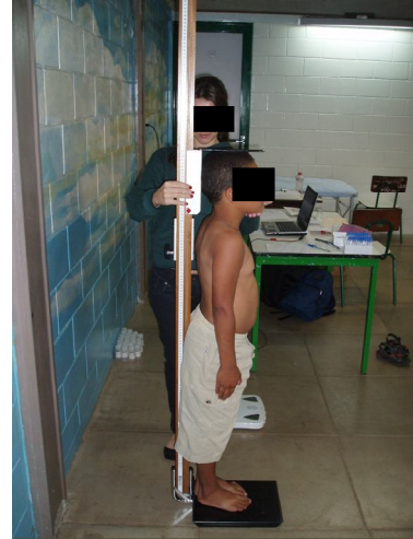
FOTOGRAFIA 2: Medida da altura de um voluntário com uso estadiometro portátil e fotografia do equipamento utilizado.
