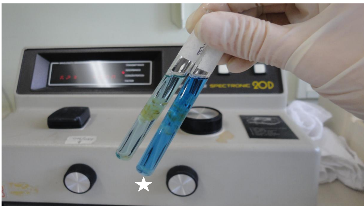
Figura 4: Leitura de absorvância das soluções de formamida, sob espectrofotometria.
