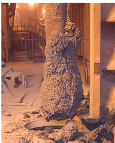
Figura 3.25 - Impregnação de metal e escória na lança de injeção de oxigênio (Documento interno ArcelorMittal Inox Brasil).
