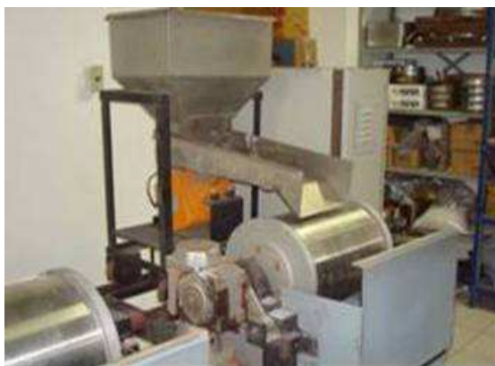
Figura 4.17 – Tambor magnético de terras-raras via úmida de médio campo magnético (7.500gauss) do Centro de Testes da Inbrás-Eriez, Diadema – SP.
