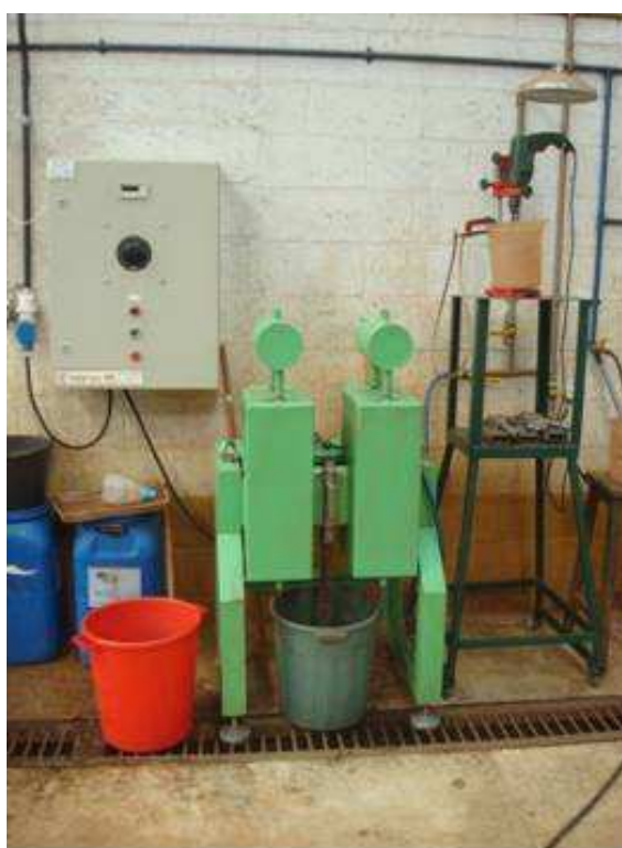
Figura 4.16 - Estrutura e equipamentos utilizados para os ensaios de concentração magnética de alta intensidade no NUTEC – Fundação Gorceix.
