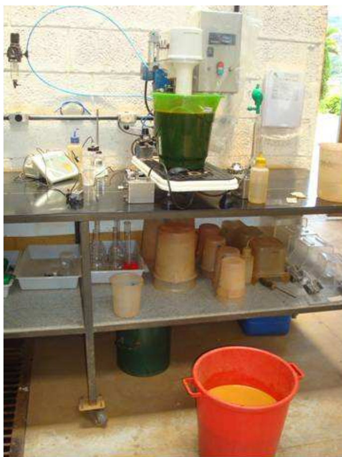
Figura 4.14 - Ensaio de deslamagem em bancada realizado para as diferentes tipologias.
