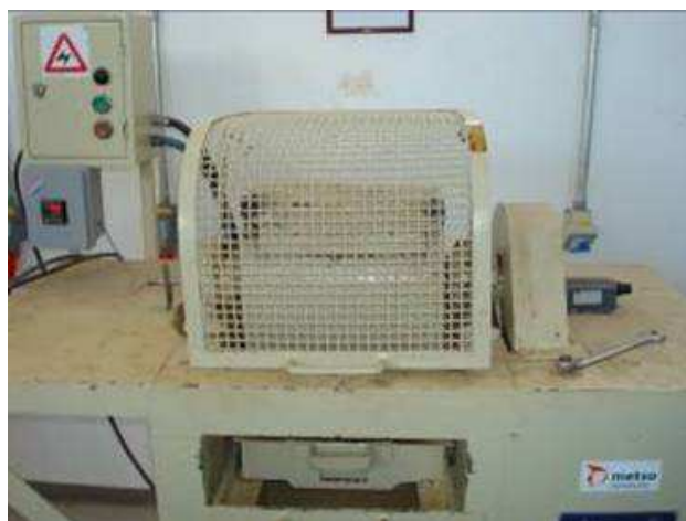
Figura 4.7 – Moinho de bolas de Bond para determinação do WI.
