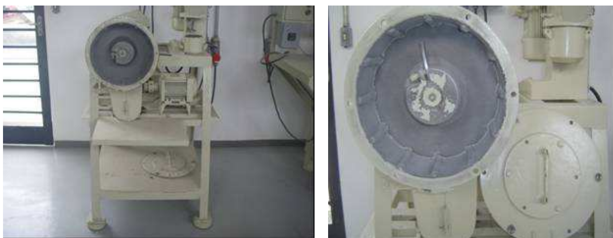
Figura 4.9 - Equipamento utilizado no ensaio de bancada para determinação do índice de abrasividade.
