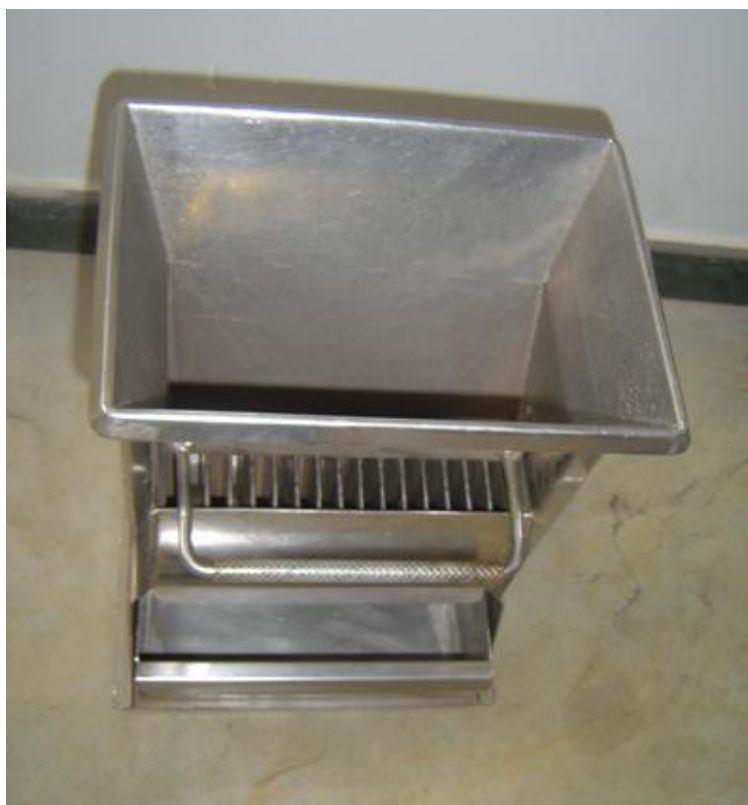
Figura 4.4: Quarteador tipo Rifles (DEMIN/UFGM).
