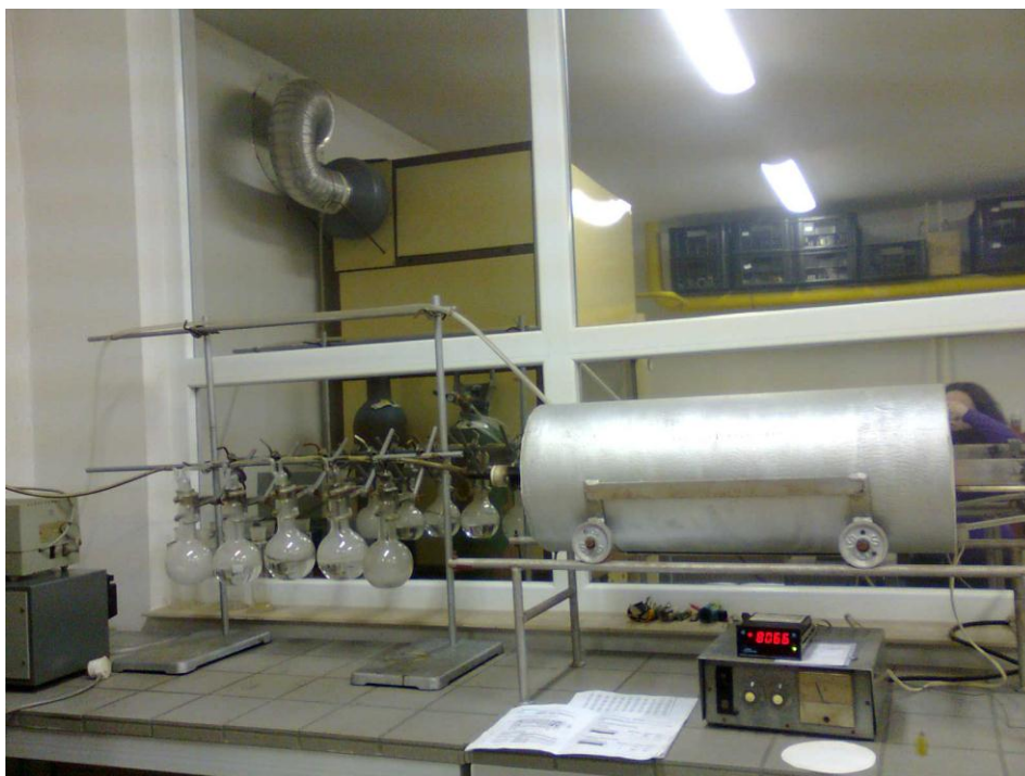
Figura 4.6: Forno calcinador equipado com sistema de coleta de gases.
