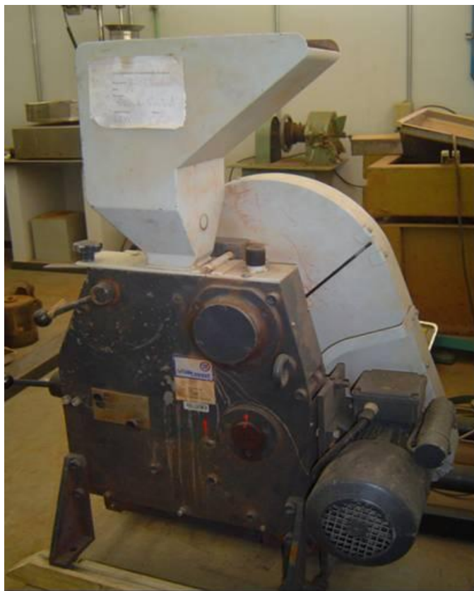
Figura 4.2: Britador de mandíbula (DEMIN/UFMG).
