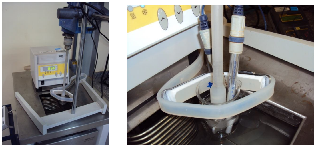
Figura 4.2. Montagem do agitador e do bico no banho termostático.
