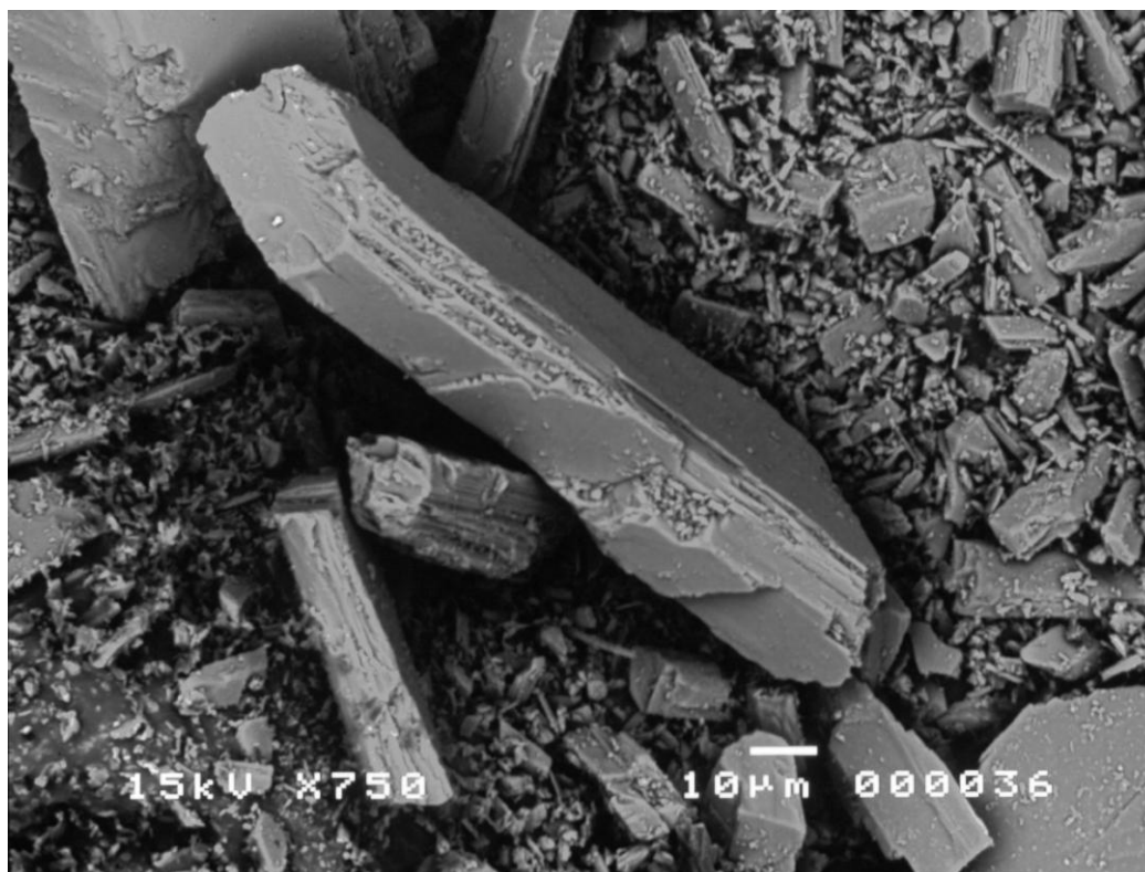
Figura 5.4: Imagem por elétrons retroespalhados da ferro-actinolita com aumento de 750 vezes.
