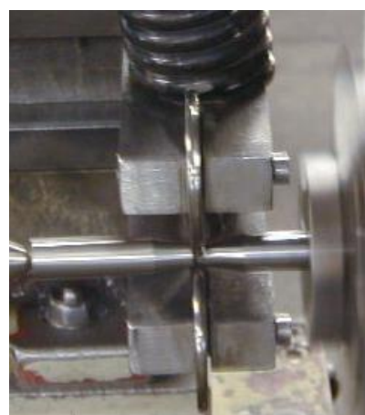
Figura 4.5: Roleteamento em corpos-de-prova para ensaio de fadiga.
