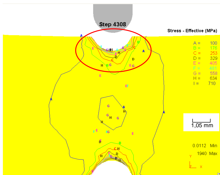
Figura 5.11: Isolinhas da tensão efetiva residual no 10 o ciclo. Fonte: Elaborado pelo autor.
