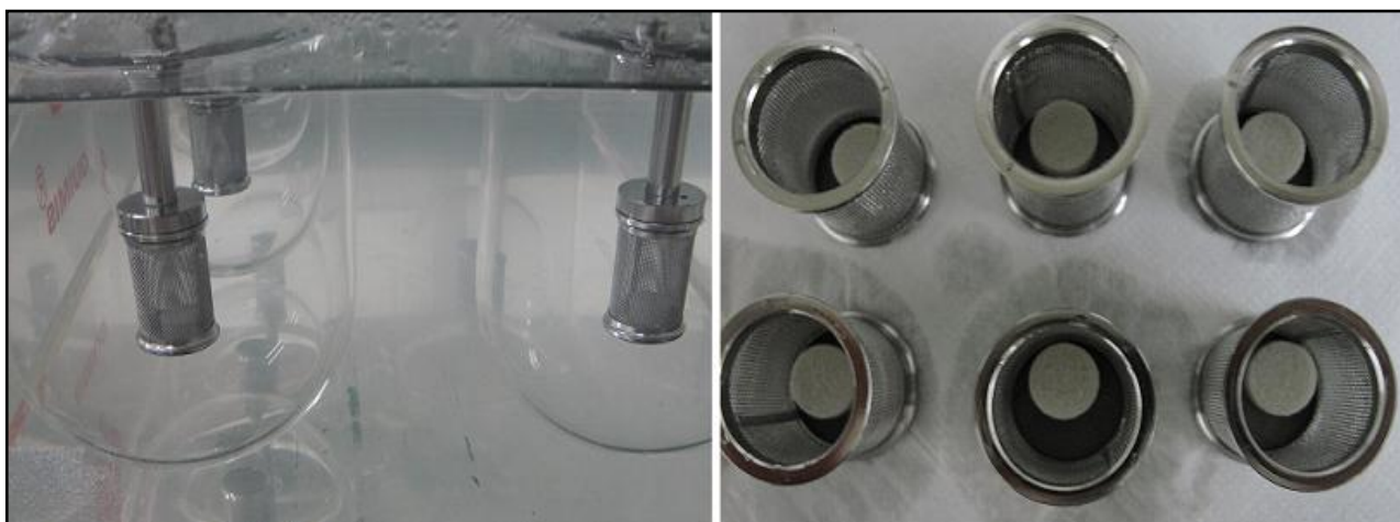
FIGURA 6.12. Fotografia dos comprimidos da Fórmula 7 contendo 48%p/p de BPEC, durante e após 12 horas de ensaio de dissolução.
