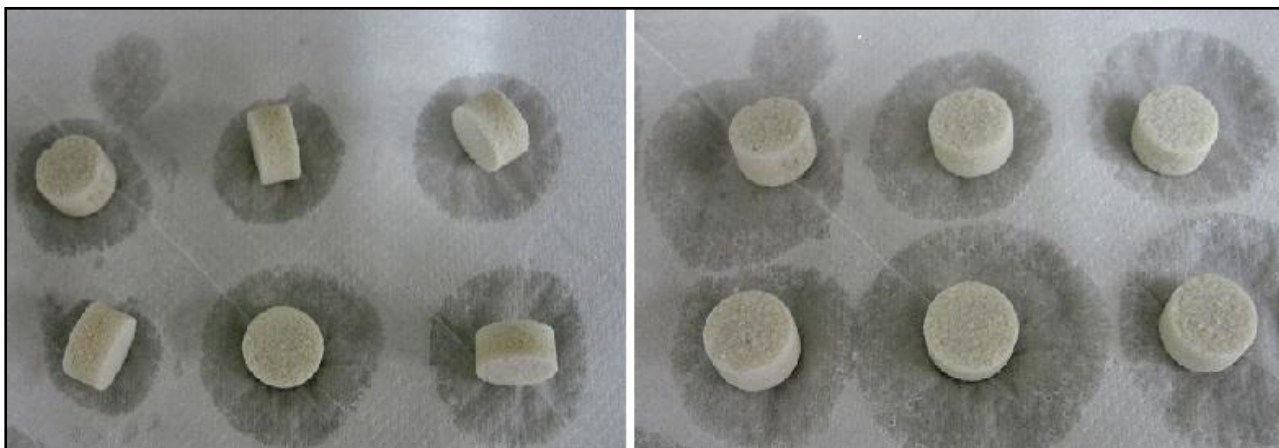
FIGURA 6.13. Fotografia dos comprimidos da Fórmula 8, contendo 64%p/p de BPEC. As matrizes permaneceram íntegras, com a formação de poros.
