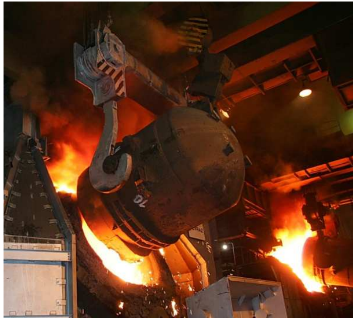
Figura 3-3 Foto de um Convertidor BOF, durante o carregamento ( www.info.industry.siemens.com ,2010).
