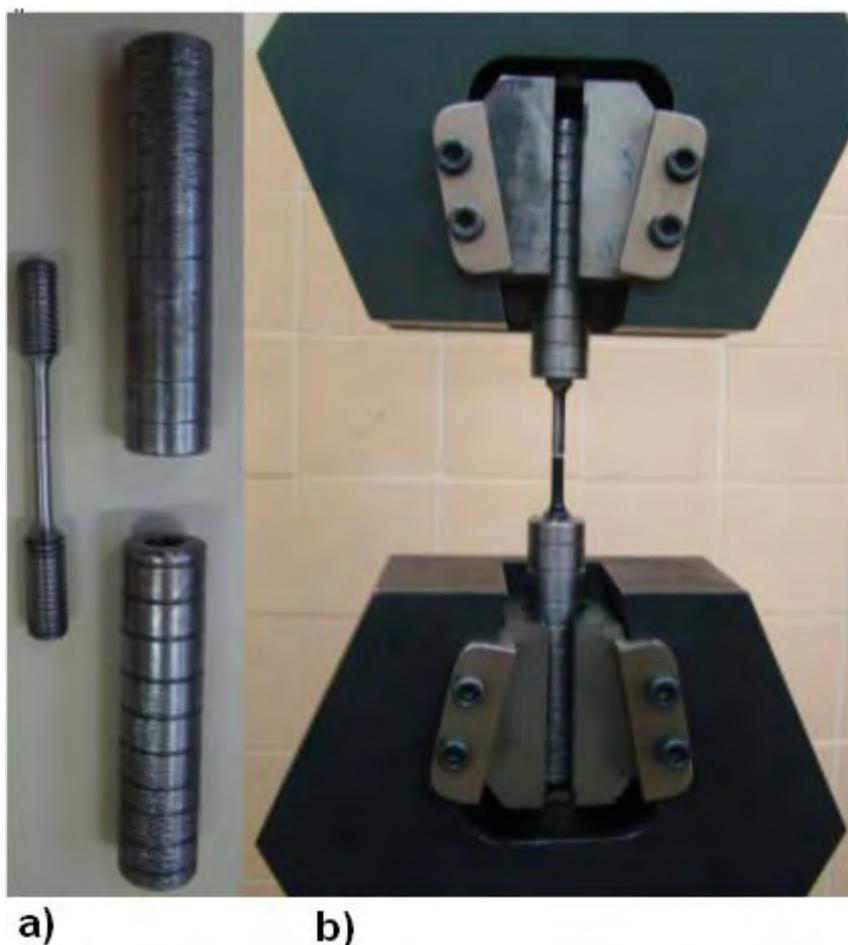
Figura 3.13 – Sistema para prender corpo de prova na garra da máquina universal de ensaios: (a) detalhe do dispositivo para rosquear o corpo de prova; (b) montagem.
