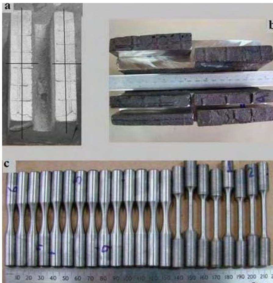
Figura 3.9 – Obtenção dos corpos de prova a partir do bloco Keel. a) keel inteiro. b) cortes das barras para pré usinagem. c) corpos de prova pré usinados.
