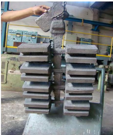
Figura 3.7 - Árvore de fundição contendo oito blocos do tipo Keel ASTM A – 781.
