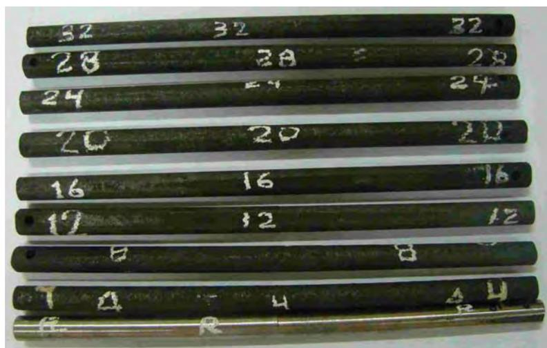
Figura 3.3 – Barras na condição de arredondadas após tratamento térmico.
