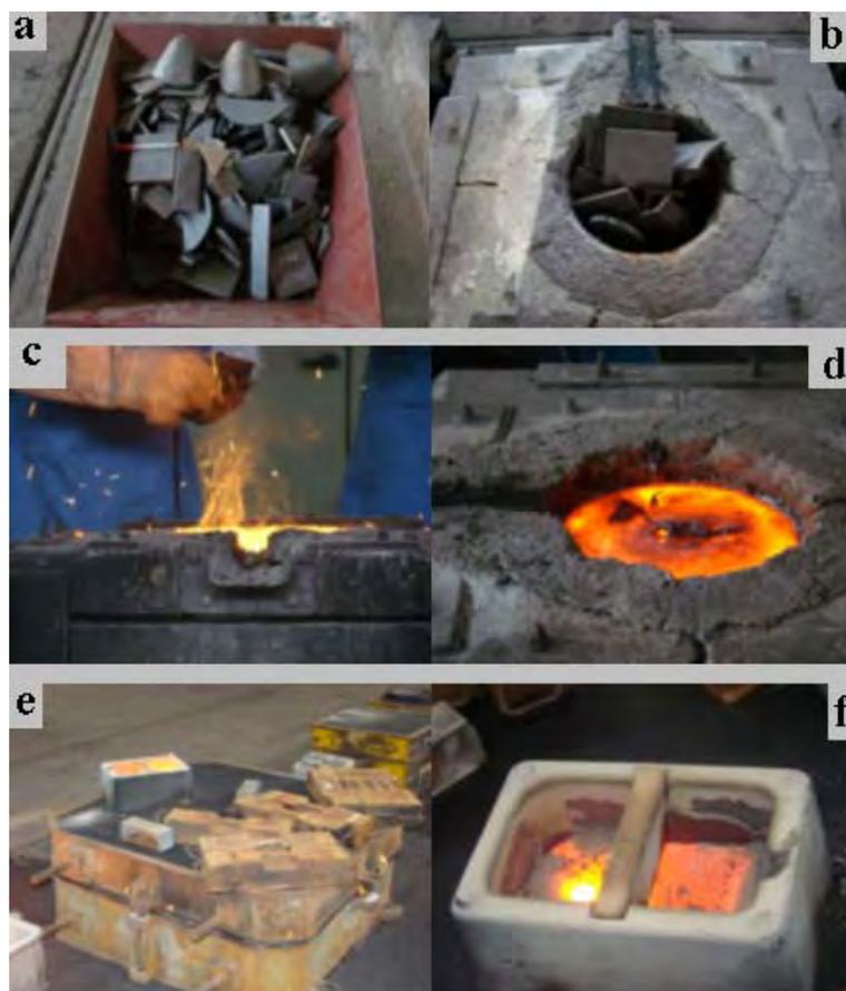
Figura 3.6 – Etapas da elaboração e do vazamento do aço.
