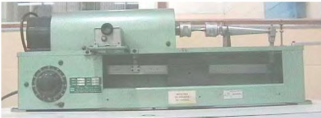
Figura 3.14 – Máquina de ensaio de fadiga por flexão rotativa.
