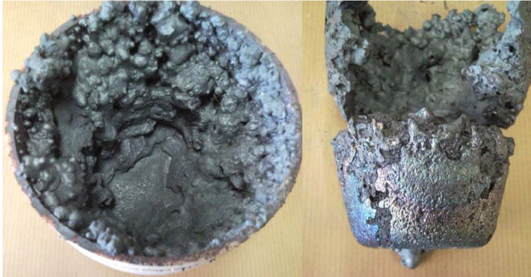
Figura 5.32: Escória solidificada na parede do cadinho. Teste O2-1.
