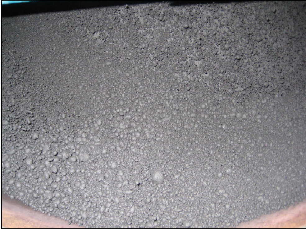
Figura 5.19: Formação das micropelotas.
