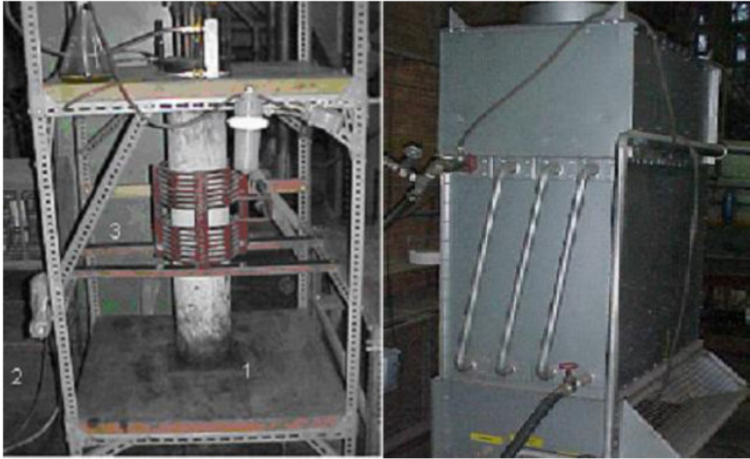
Figura 5.27: Ilustração do forno de indução com seus auxiliares, forno de indução (1), transformador de voltagem (2), controlador de potência (3), além da torre de resfriamento.
