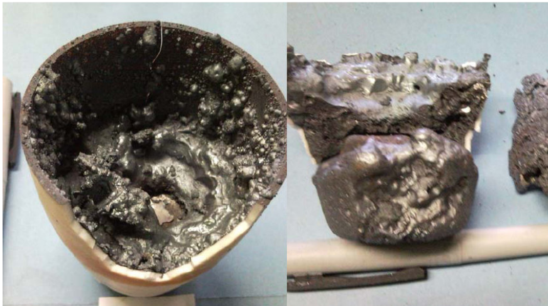
Figura 5.33: Escória solidificada com presença de metal entrante. Teste O2-2.
