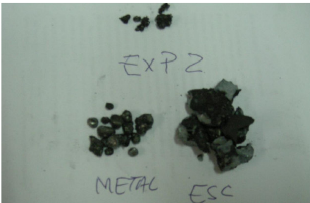
Figura 5.28: Glóbulos metálicos e escória após ensaio de redução-fusão.
