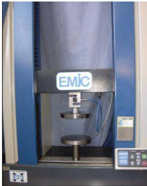
Figura 4.4: Máquina para o ensaio de compressão (EMIC – Modelo DL 3000) do Laboratório de Engenharia de Polímeros e Compósitos – LEPCOM (Departamento de Engenharia Metalúrgica e de Materiais da UFMG)
