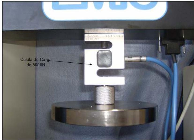
Figura 4.5: Fotografia do aparelho para teste de compressão mostrando em detalhe a célula de carga utilizada.
