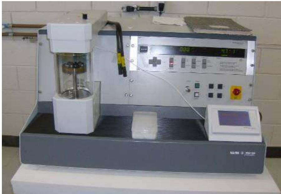
Figura 4.9: Aparelho para metalização de superfície (BAL-TEC MCS 010)
