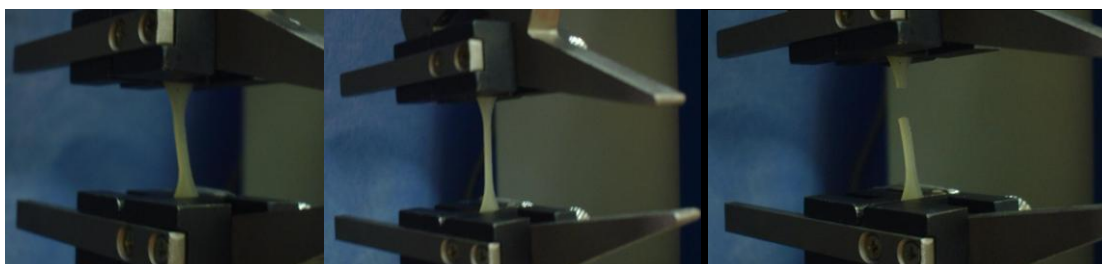
Figura 5.5: Ensaio de tração realizado com os biomateriais
