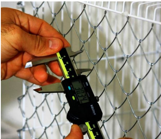
Figura 8: Medição de tela de simples torção segundo definição da norma ABNT com paquímetro.
