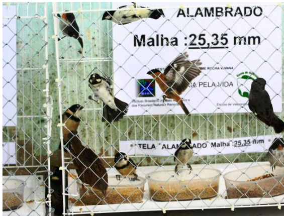
Figura 18: Passagem Natural Viveiro. Momento da passagem da espécie Sporophila lineola na malha 25,35mm.
