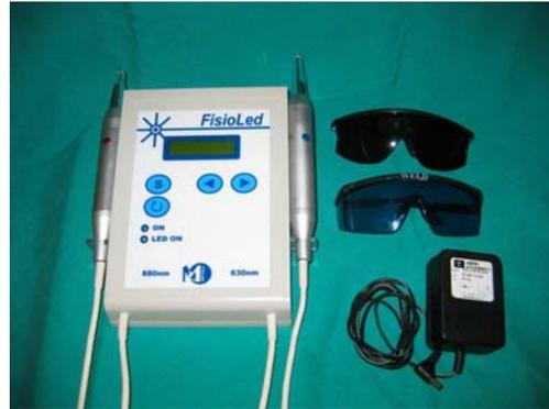
Figura 13. Imagem fotográfica do equipamento LED. Esquerda: aparelho FizioLed® da MMOptics; direita acima: óculos de proteção; direita abaixo: fonte de energia.
