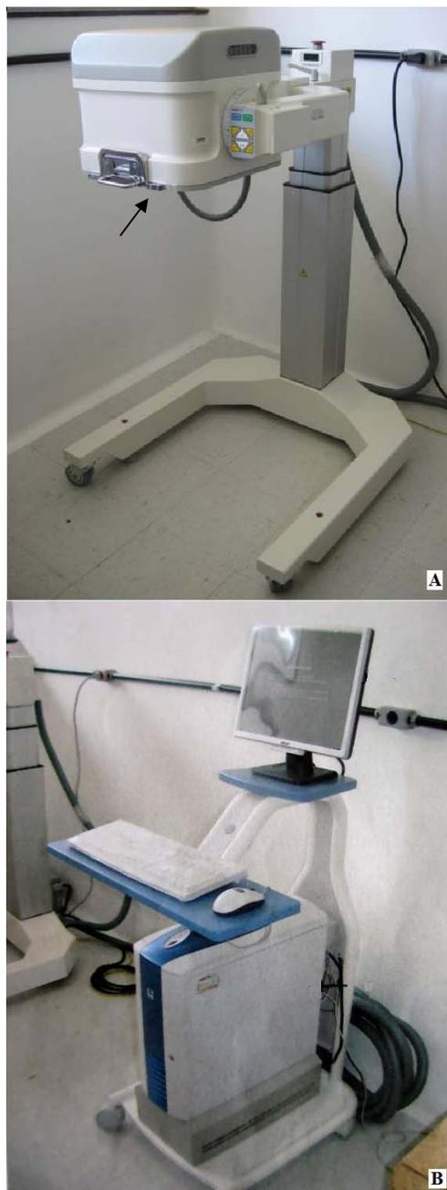
Figura 15. Imagem fotográfica da Gamacâmara Nucline TH/22. (A) Detector de radiação, colimador LEHR (seta). (B) computador de aquisição de imagens.
