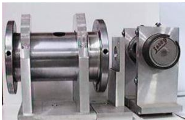
Figura A.7 – Transdutor, suporte de amostras e detector de um espectrômetro Mössbauer.
