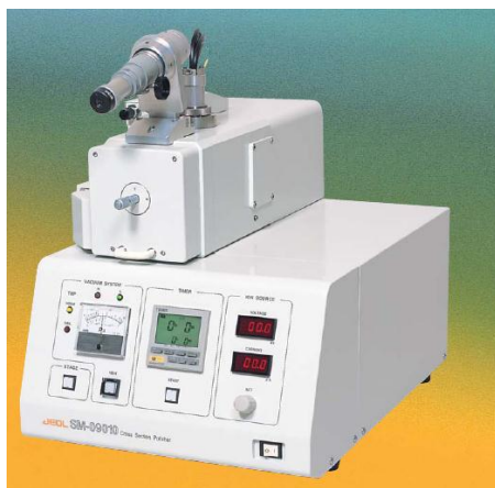
Figura 4.4 – Ilustração do equipamento utilizado para realização do polimento iônico (69) .
