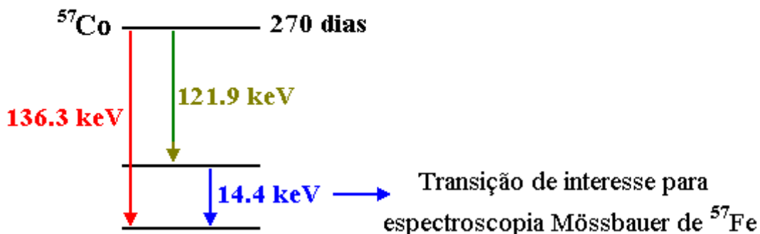
Figura A.10 – Emissões de raios \gamma para o decaimento de ^{57}\text{Co} .
