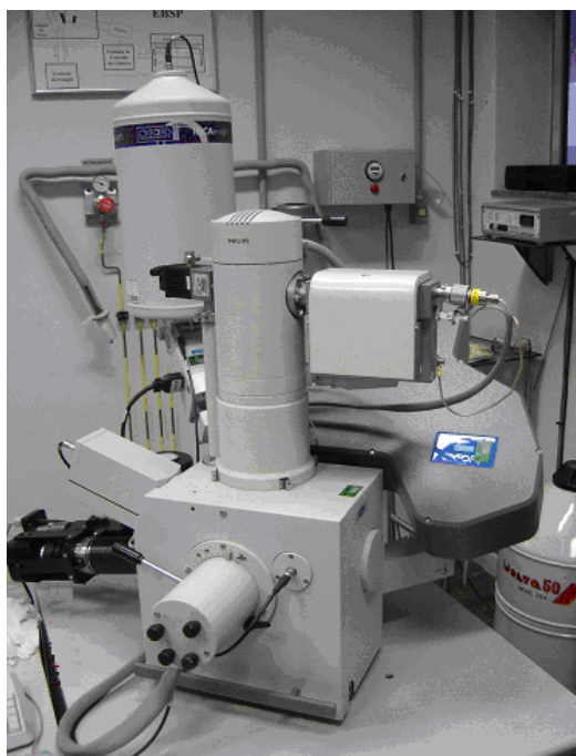
Figura 4.4 Microscópio eletrônico de varredura do laboratório de métodos físicos do Centro de Pesquisas da ArcelorMittal Inox Brasil (RODRIGUES, 2008).
