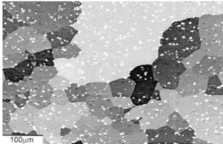
Fig. 11 Crescimento anormal dos grãos em Al-1%Mg-1%Mn recozido em 600°C
