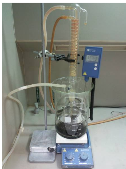
Fig. 21 Detalhes da montagem experimental para extração de nitretos
