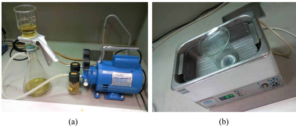
Fig. 22 (a) Detalhes da filtração a vácuo através da membrana de teflon e (b) banho ultrasônico da membrana filtradora em HCl.
