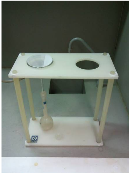
Fig. 23 Filtragem final com papel filtro e armazenamento em balão da solução que reagiu com HCl e HNO 3 Resultados
