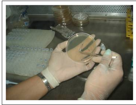
FIGURA 3.16 – Procedimento de sementeira do meio com os microorganismos na placa de Petri .
