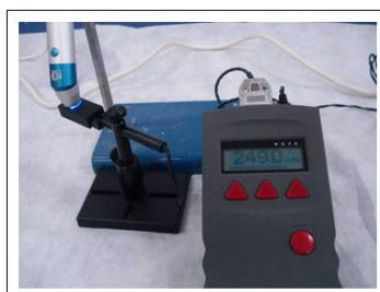
FIGURA 4.4 - Verificação da potência do LED utilizando medidor de potência POWER METER (NOVA- Israel)
