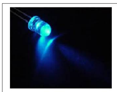
FIGURA 2.1 - LED emissor de luz azul FONTE - www.infoleds.wordpress.com (acesso em 31/08/2010)
