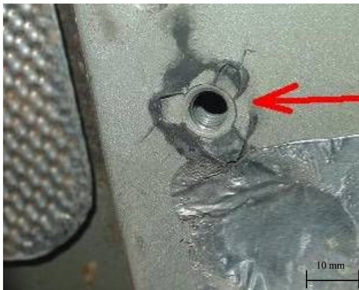
Figura 14. Trinca na fixação do sistema de escapamento – Ferreira e Bracarense 2010.
