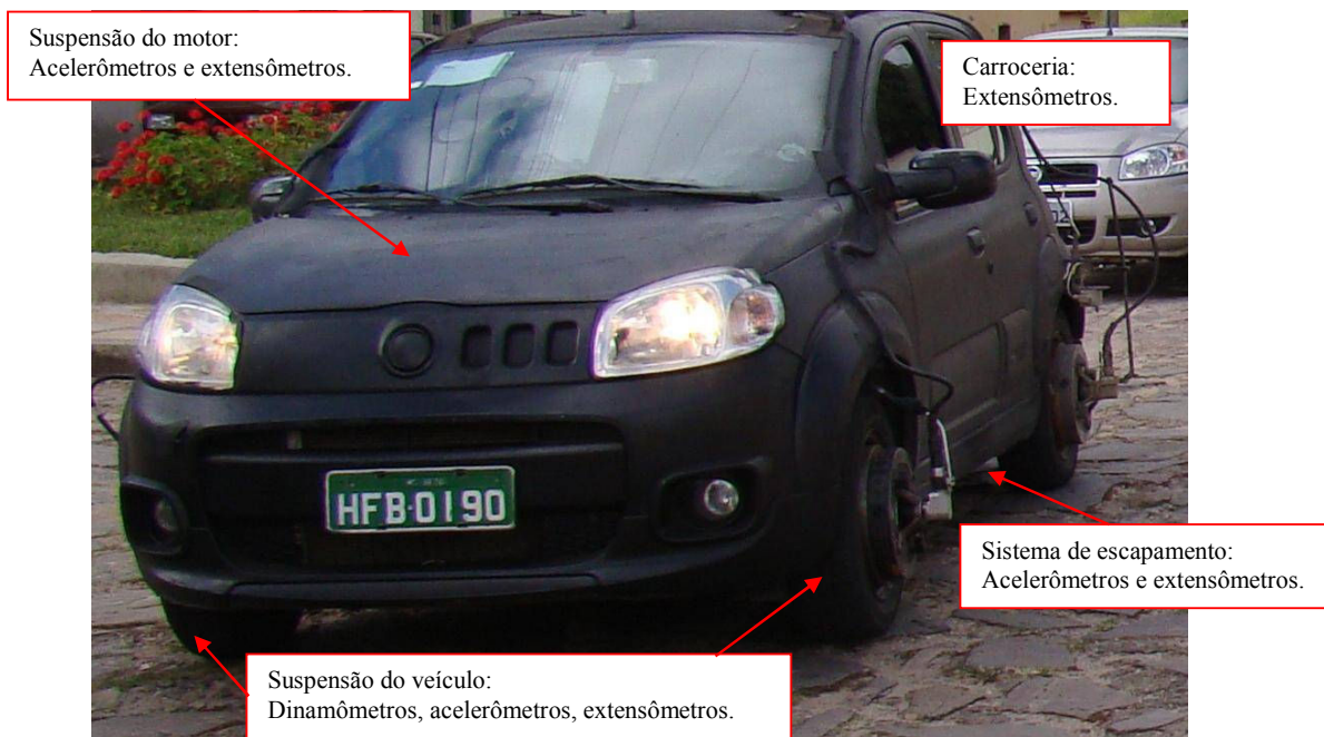
Figura 30. Visão geral da instrumentação no veículo.
