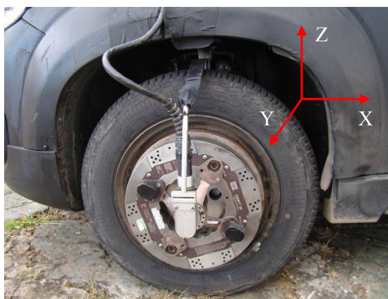
Figura 32. O dinamômetro utilizado nas rodas do veículo.
