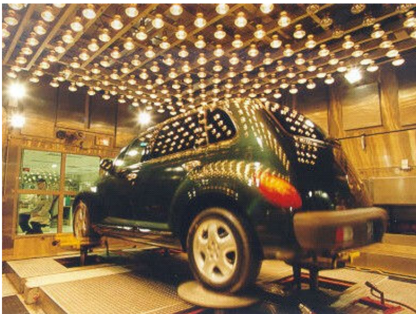
Figura 28. Simulador de estradas tipo Four-Poster – cortesia Chrysler.
