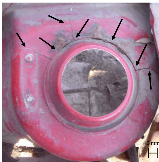
Figura 15. Trinca na torre do amortecedor dianteiro – He et al 2009.
