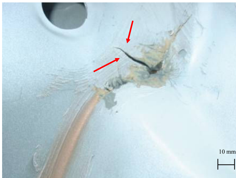
Figura 13. Trinca no nó H de um veículo de passeio – Fonte Fiat Automóveis S/A.
