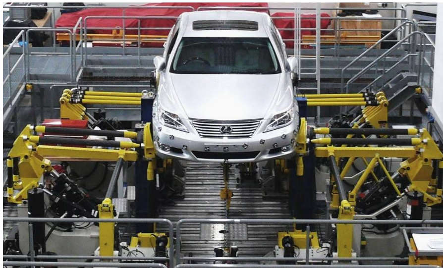
Figura 29. Simulador de estradas de seis graus de liberdade – cortesia Toyota.
