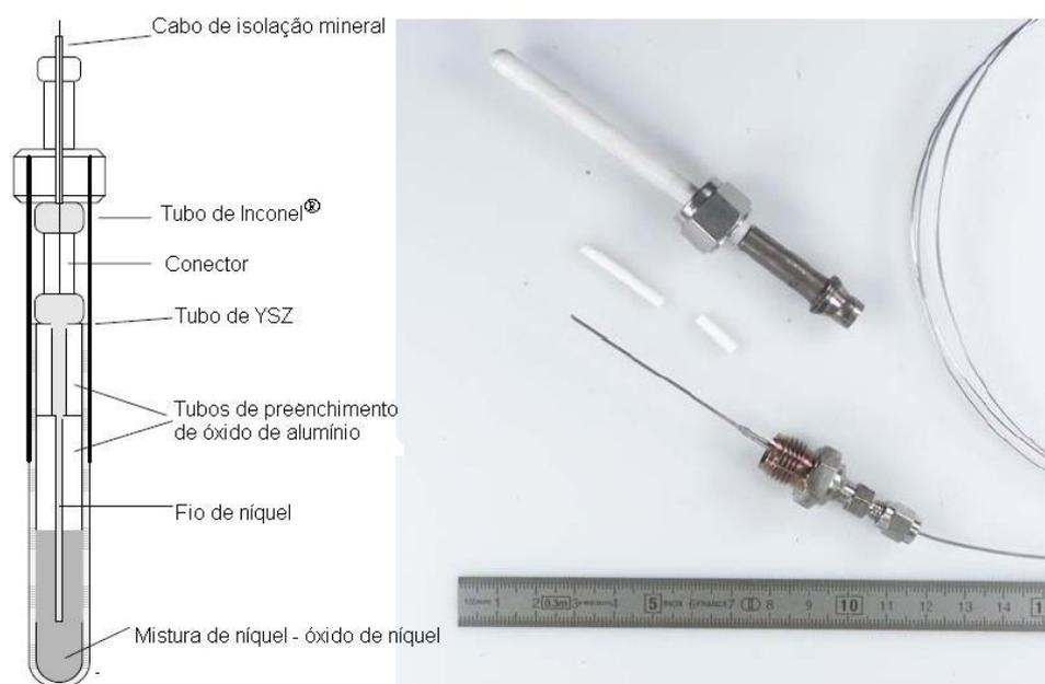
FIGURA 3.7 - Desenho esquemático e fotografia do eletrodo de referência YSZ Ni/NiO. Fonte: Bosch, 2005 ó modificada.
