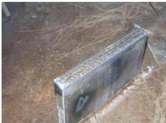
FIGURA 4.1 ó Camada de amanteigamento aplicada ao aço do tipo ASTM A-508 G3 utilizando o metal de adiço liga de nquel 82.
