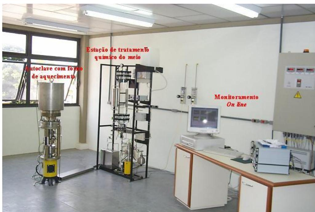
FIGURA 3.10 ó Instalação para estudos de suscetibilidade à CST ó fabricação instituto nuclear NRI efl.
