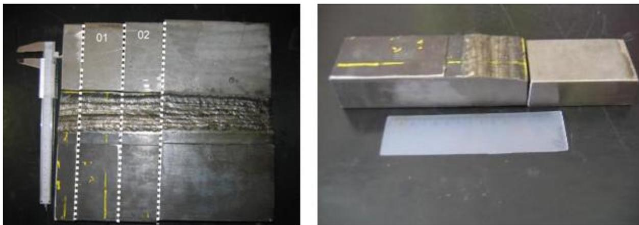
FIGURA 4.4 Local de retirada dos corpos-de-prova.
