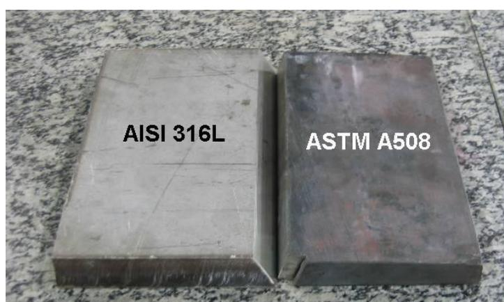
FIGURA 3.1 ó Materiais de base utilizados no procedimento de soldagem, chanfro em V.
