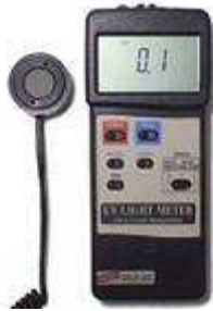
Figura 4.9 – Medidor de luz ultravioleta digital
