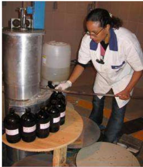
Figura 4.10 – Posicionamento das amostras no irradiador
