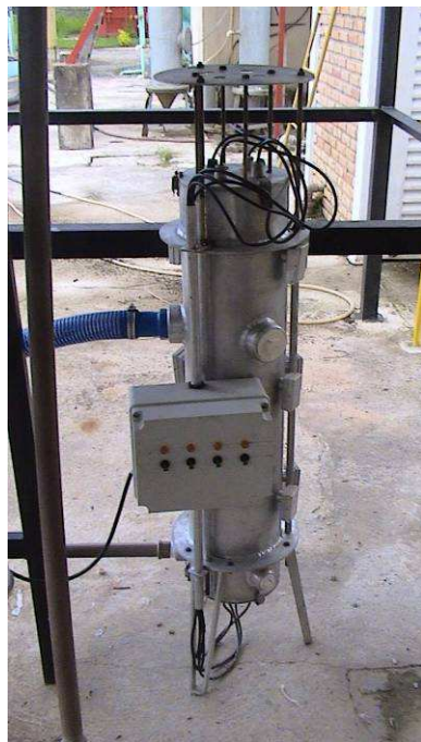
Figura 4.4 – Foto e esquema do fotorreator de lâmpadas imersas (FRI) Fonte: Alves (2003)
