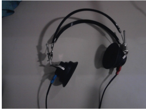
FIGURA 3.3 – Fone de ouvido TDH39 utilizado nos exames de audiometria e testes com NPSE.
