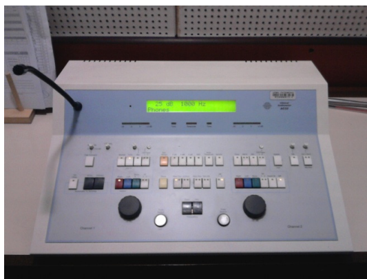
FIGURA 3.2 - Audiômetro AC33 utilizado na audiometria e teste com NPSE
