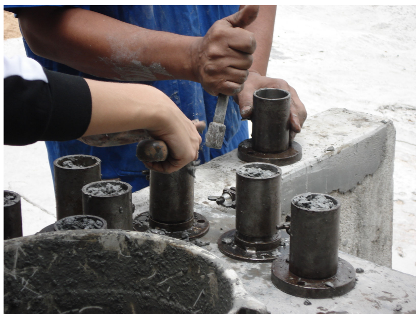
FIGURA 3.9 – Moldagem dos corpos-de-prova cilíndricos
