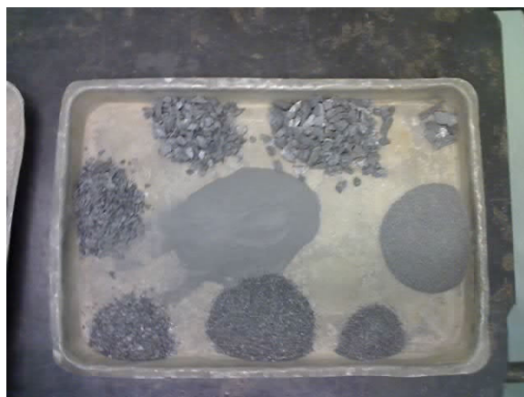
FIGURA 3.5 - Representação da granulométrica do agregado com sulfeto de Irapé
