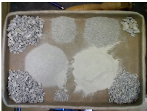
FIGURA 3.1 - Representação da granulométrica do agregado de gnaisse
