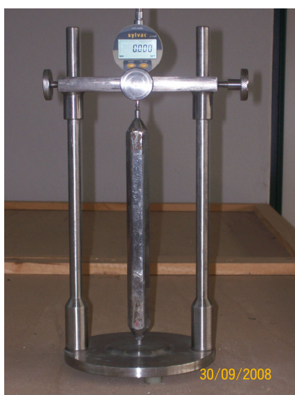
FIGURA 3.10 - Equipamento de medida da expansão nas barras de concreto e argamassa
