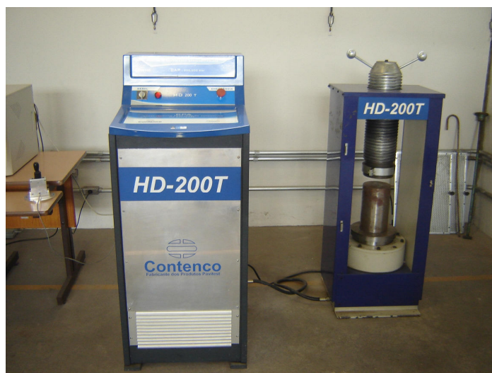
FIGURA 3.11 – Prensa usada para os ensaios de resistência à compressão e tração
