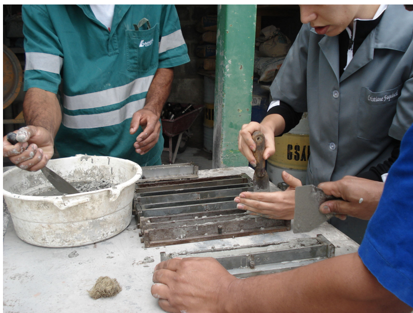
FIGURA 3.8 – Moldagem dos corpos-de-prova prismáticos
