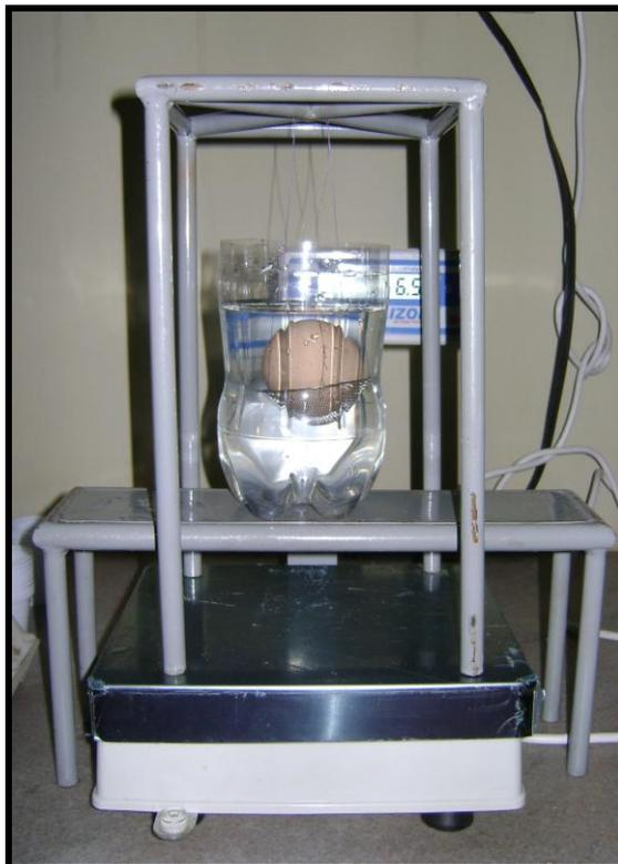
Figura 12. Equipamento utilizado para a análise do peso específico dos ovos. Arquivo pessoal.
