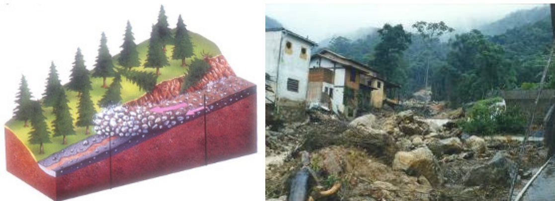
FIGURA 3.13 - Esquema representando as corridas de massa (Fonte: Ministério das Cidades, 2007).
