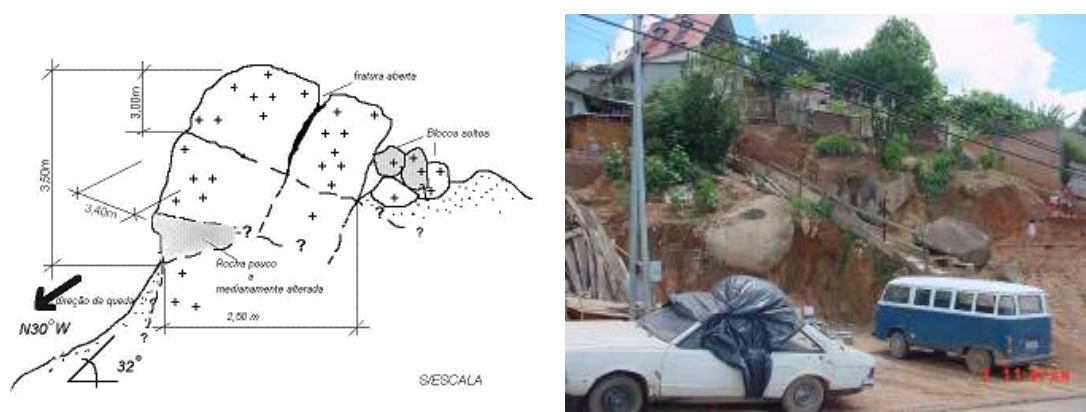
FIGURA 3.12 - Esquema representando o rolamento de blocos (Fonte: Ministério das Cidades, 2007).
