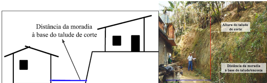
FIGURA 4.28 – Relação altura/afastamento da encosta a montante da edificação (Fonte: Ministério das Cidades, 2007).
