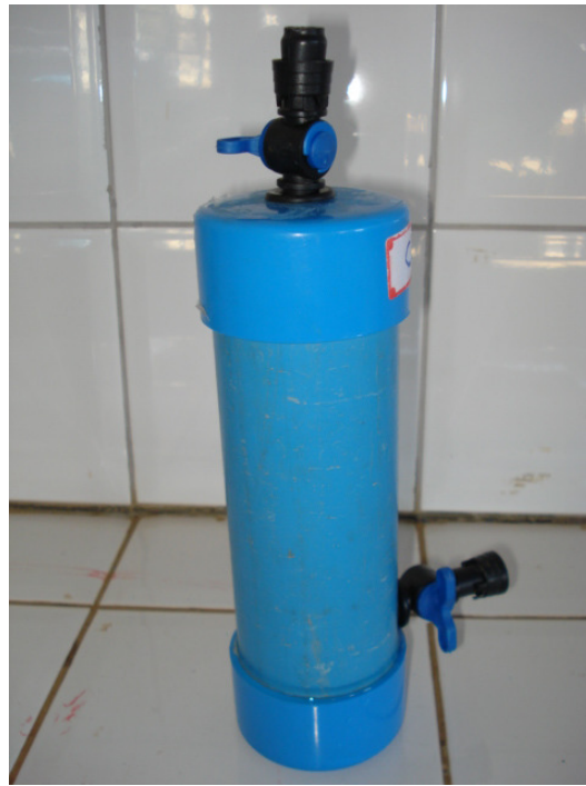
FIGURA 4.10 - Sistema montado para a coleta de amostra de água durante a injeção de \text{CO}_2
