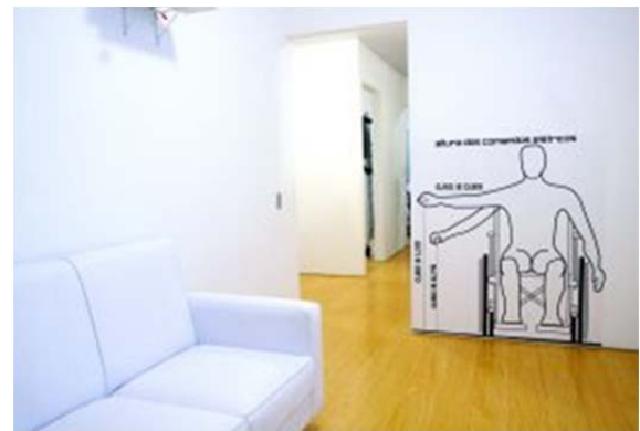
FOTO 4- Casa acessível: Espaço livre para circulação, altura de interruptores, tomadas para qualquer usuário, passagem com dimensionamento de 90 cm.
