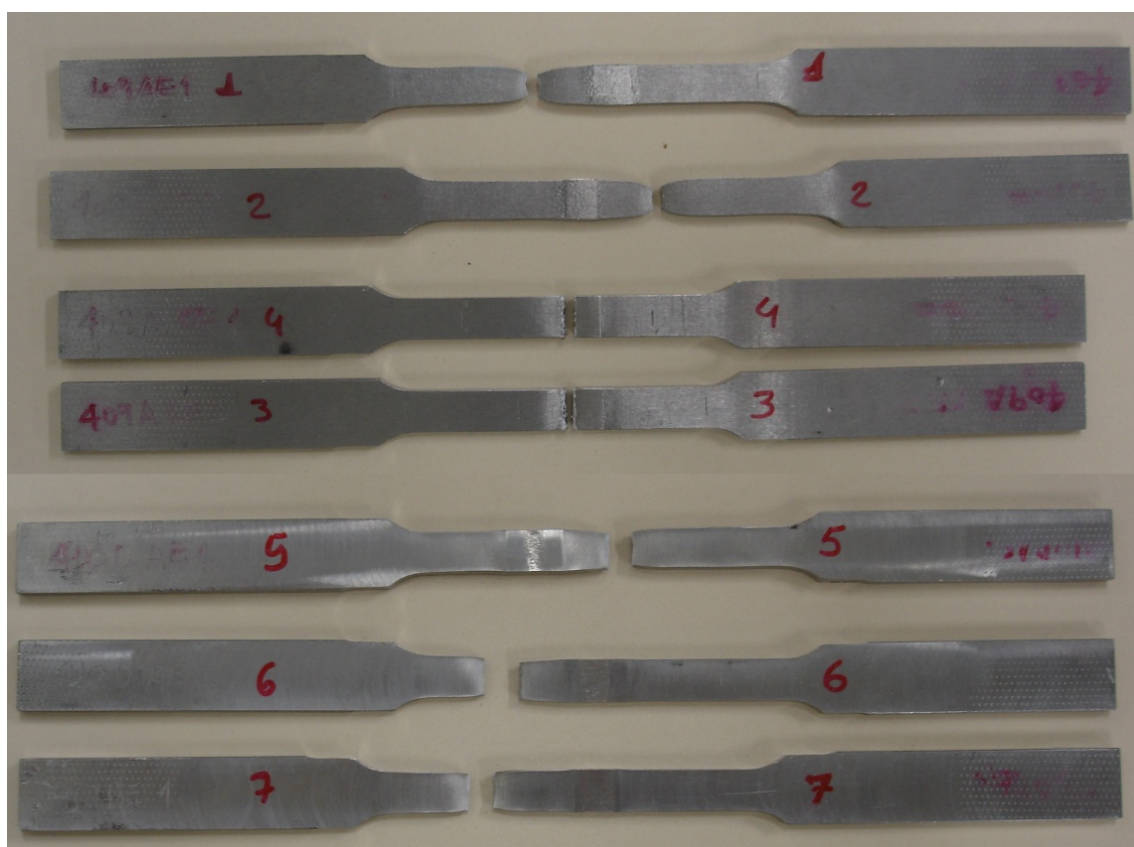
Figura 5.51 Corpos de prova dos dois aços com solda, após ensaio de tração. Numeração dos corpos de prova: 1 a 4: S40910 e 5 a 7: S41003.
