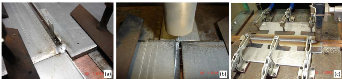
Figura 5.36 a) Amostra preparada para soldagem na bancada GMAW (b) Posição da tocha de soldagem GMAW sobre o chanfro meio-V (c) Solda realizada na bancada.
