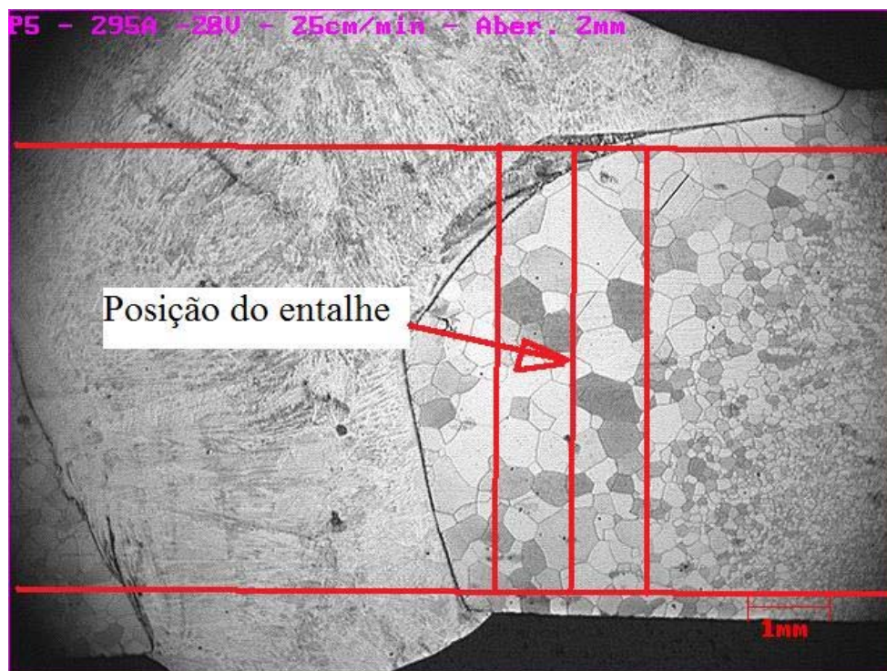
Figura 4.8 Retirada do corpo de prova e posição do entalhe para ensaio de impacto Charpy.
