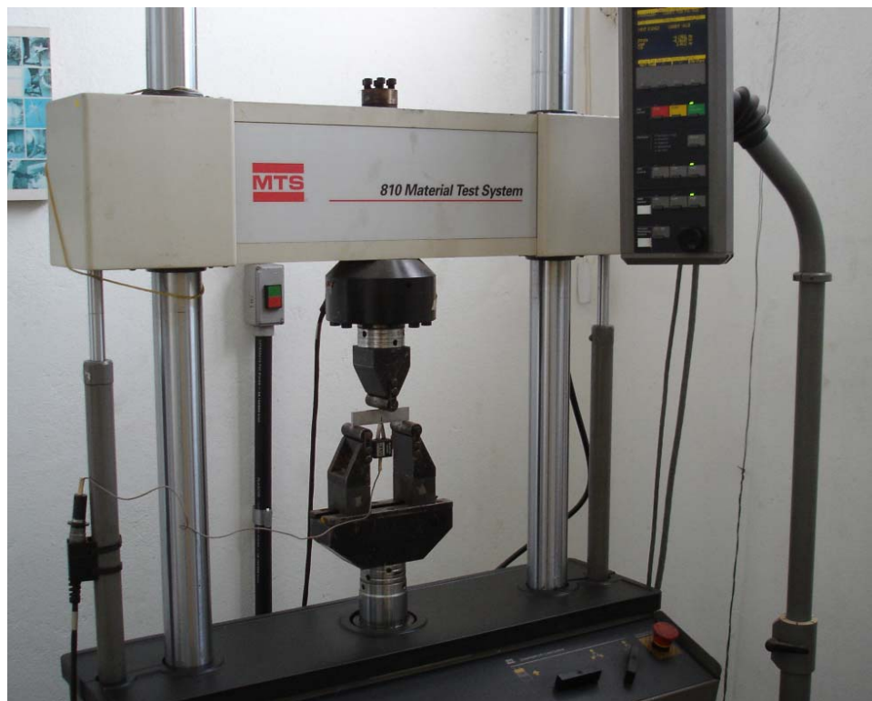
Figura 4.2 Equipamento e dispositivos para ensaio de tenacidade à fratura por flexão em corpo de prova SE(B).
