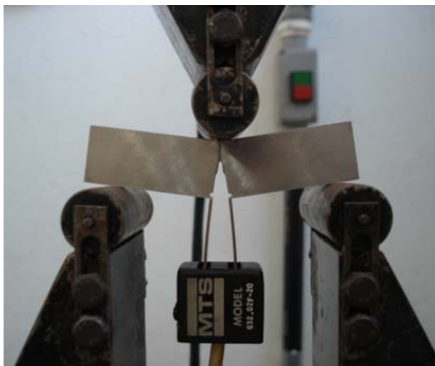
Figura 4.3 Detalhe do dispositivo de ensaio, com corpo de prova deformado após ensaio e clip-gage posicionado para medição de abertura da boca do entalhe (CMOD).
