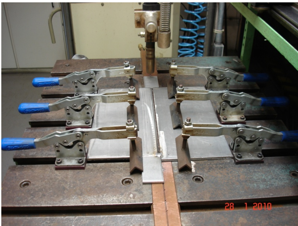
Figura 4.5 Bancada de soldagem GMAW preparada para soldagem (AMIB).
