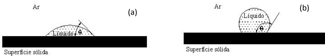
Figura 3.4 - Ângulo de contato para gota de líquido em contato com superfície sólida imersa no ar: (a) partícula fracamente hidrofóbica - \theta < 90^\circ ; (b) partícula fortemente hidrofóbica - \theta > 90^\circ (LEJA, 1982).
