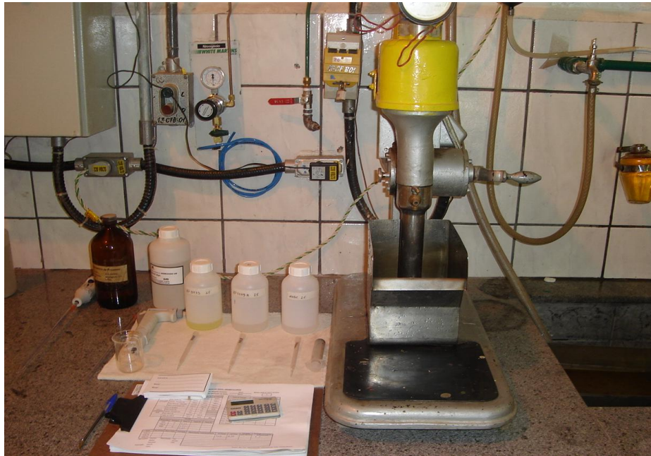
Figura 5.2: Célula de flotação utilizada nos testes de laboratório.
