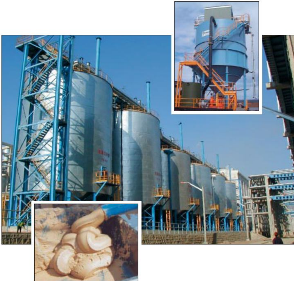
Figura 1.2: Exemplo de um espessador de pastas. (EIMCO, 2008)
